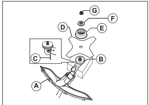
5. Stellen Sie sicher, dass das Mitnehmerrad und der Stützflansch korrekt im Mittelloch der Grasklinge einrasten.
