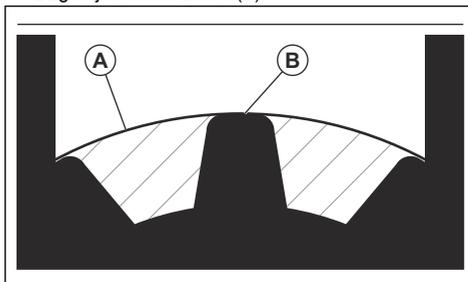
5. Če je raven masti prenizka, poševni prenos napolnite Husqvarna z mastjo za kotne prenose. Počasi napolnite in obrnite pogonsko gred, ko nanašate mast za kotne prenose, ustavite na ustrezni ravni (B).
