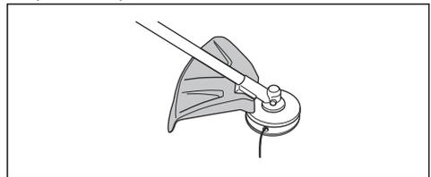
3. Ersetzen Sie den Schutz für die Schneidausrüstung, wenn er beschädigt ist.
