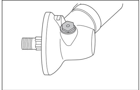
4. Sehen Sie in die Schmiernippel-Öffnung hinein, und drehen Sie die Antriebswelle. Der Schmierfettstand (A) muss sich auf Höhe der Zahnoberseite (B) befinden.
