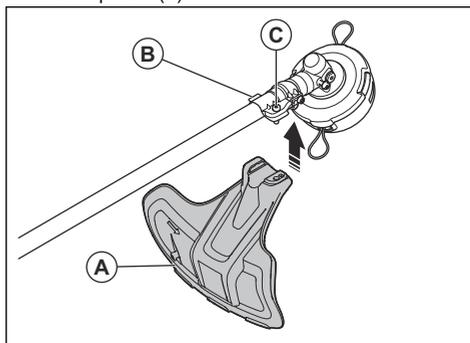
2. Ščitnik rezalnega priključka namestite na gred in ga pritrđite z vijakom (C).
