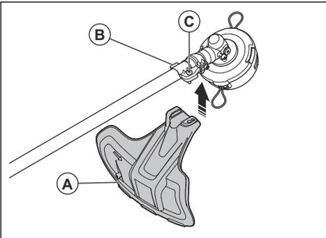
2. Bringen Sie den Schutz für die Schneidausrüstung an der Welle an und ziehen Sie ihn mit der Schraube (C) fest.
