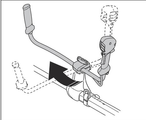
3. Drehen Sie den Lenker um den Schaft, bis die Lenkerklemme in der Transportposition einrastet.
