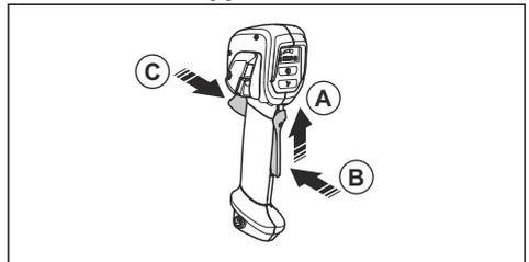
1. Kontrollieren Sie, ob der Gashebel gesperrt ist, wenn sich die Sperre in der Ausgangsstellung befindet.
