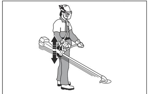
5. Wenn Gras geschnitten werden soll, lassen Sie die Schneidausrüstung leicht auf dem Boden bleiben. Stellen Sie den Aufhängungspunkt ein, um das Gerät korrekt auszubalancieren.
